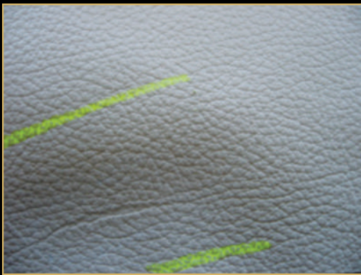
Prasklina na líci zastříkaná úpravou
